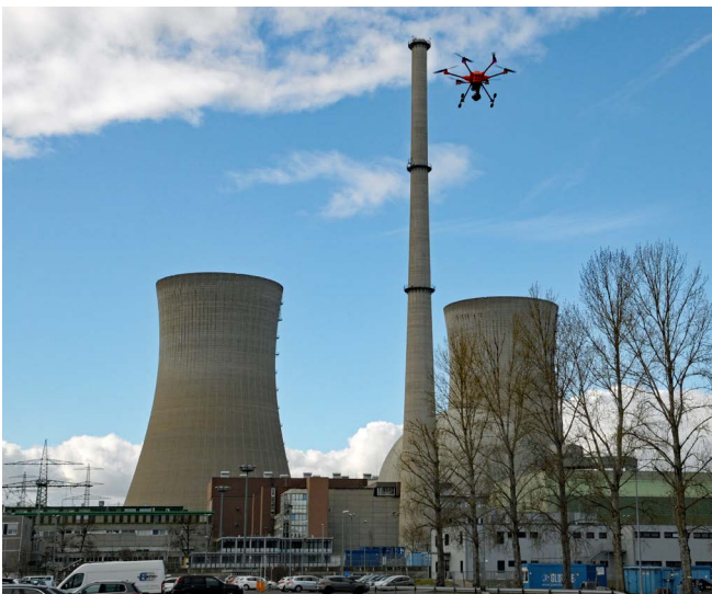
Abb. 1 Inspektionsflug mit Multikopter
