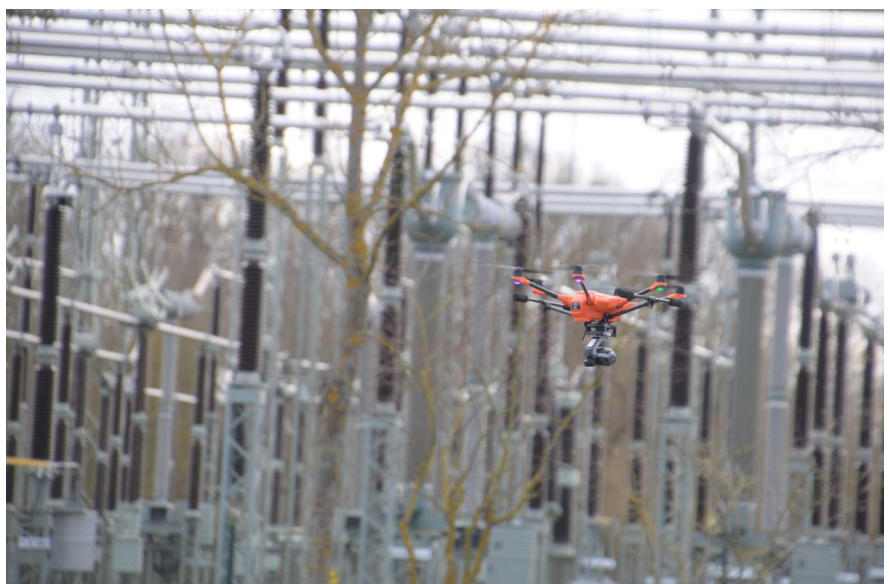
Abb. 19 Inspektionsflug im Hochspannungsfeld
