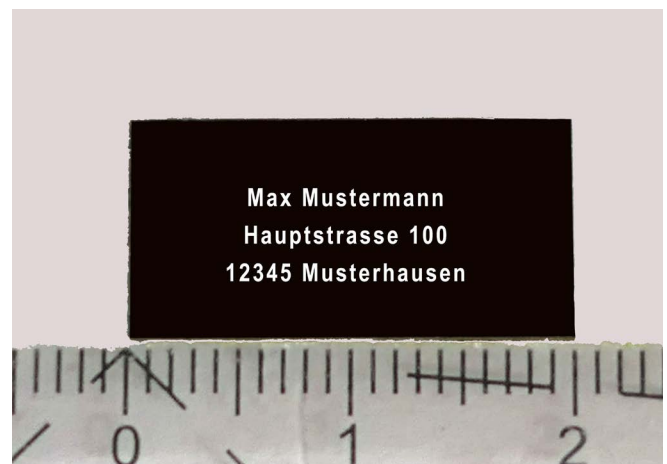
Abb. 4 Beispielhafte Kennzeichnung entsprechend Drohnenverordnung
